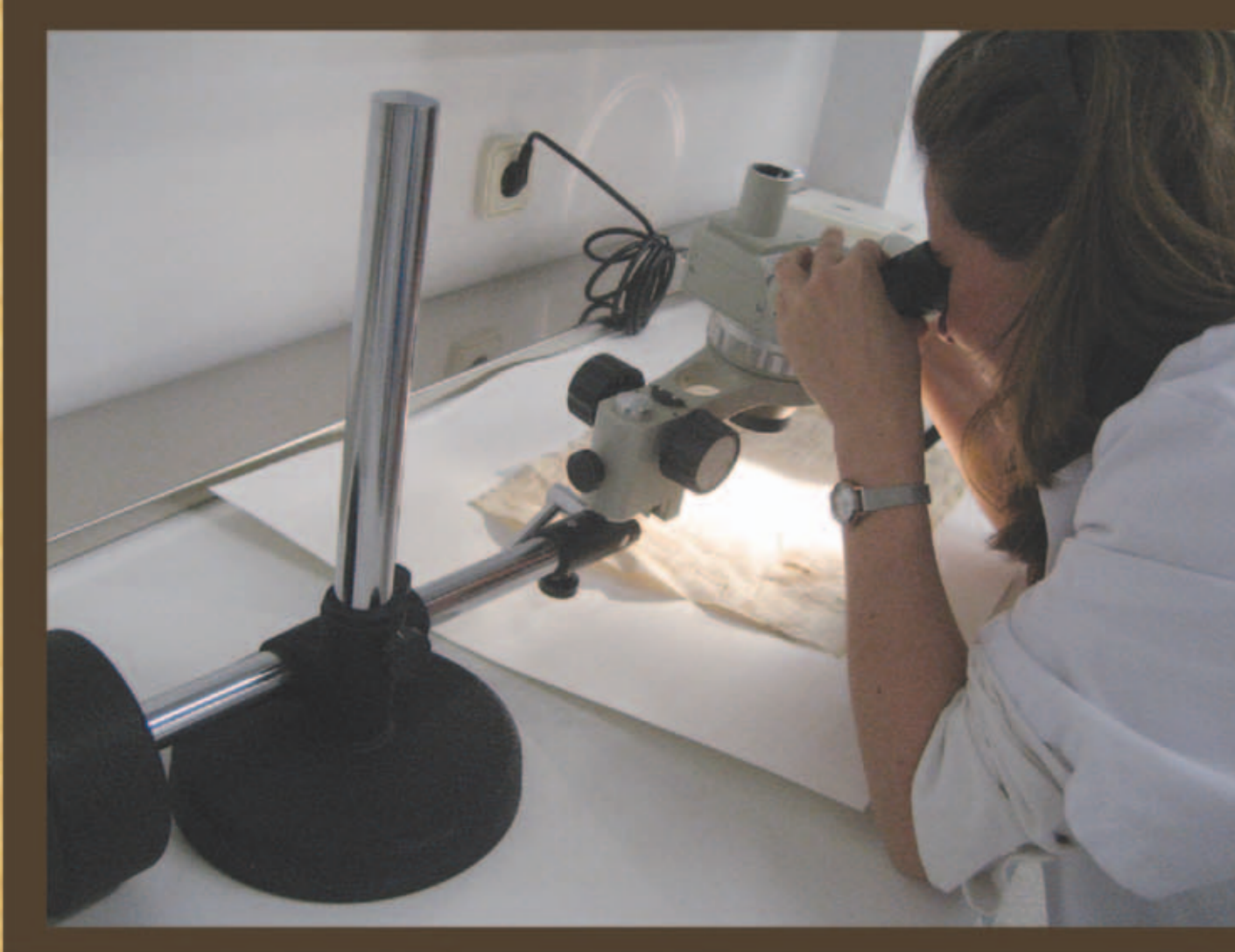
Prueba de solubilidad de tintas. Observando los efectos de una microgota de agua con lupa binocular
