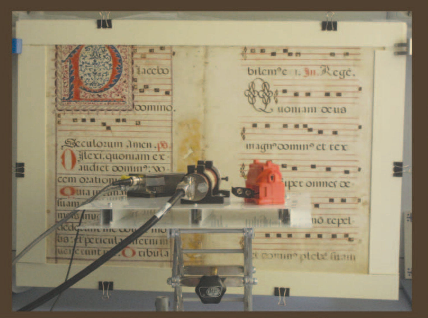
Análisis mediante fluorescencia de rayos X. Permite la identificación de los pigmentos inorgánicos
