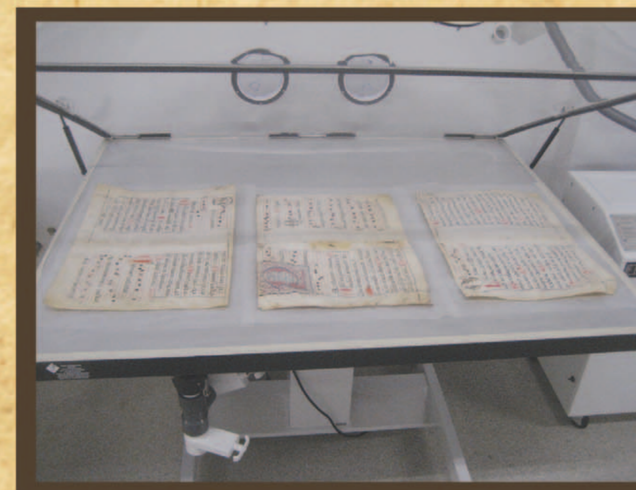
Estabilización del pergamino en cámara de humectación. Alisado del pergamino por tensión perimetral
