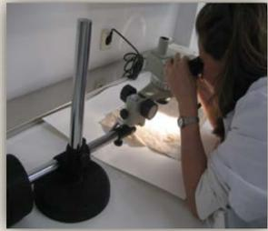
*Prueba de solubilidad de tintas: mediante lupa binocular se observan los efectos de una microgota de agua*
